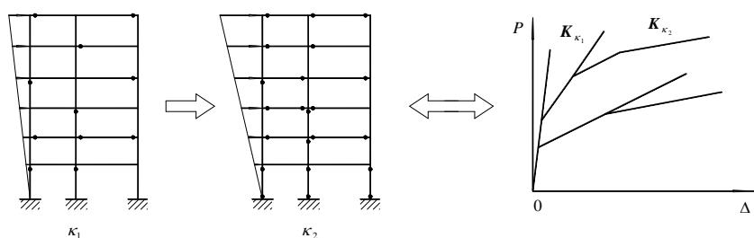
图 3.1 非线性构形状态转移过程示意图
